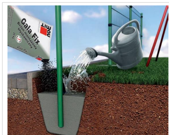
Mocowanie słupka ogrodzeniowego przy pomocy Baumit Gala Fix - bez konieczności mechanicznego mieszania zaprawy.
