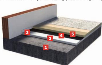
Podkład pływający z ogrzewaniem podłogowym (grzewczy) na warstwie termoizolacji
