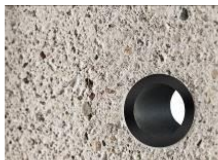
Przekrój jastrychu płynnego Alpha 2500 z przewodem grzewczym
