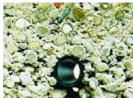
Przekrój tradycyjnego jastrychu cementowego z przewodem grzewczym Fot. Baumit
